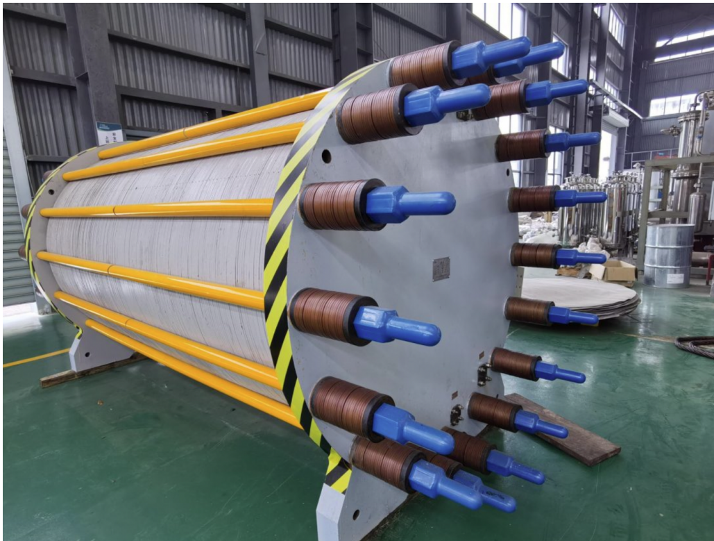
Fig. 19: Illustration d'une pile d'électrolyseur de 5 [MW elec ], fabriquée par l'entreprise John Cockerill Energy (John Cockerill Renewables, nd).
