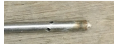
Figure 4-35 : Zoom sur les ouvertures (tube droit)
