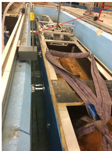
Figure 4-59 : Image modèle réduit - Prises de pression avec bateau - Cas Bajoyer ( P_{diff-2} )
