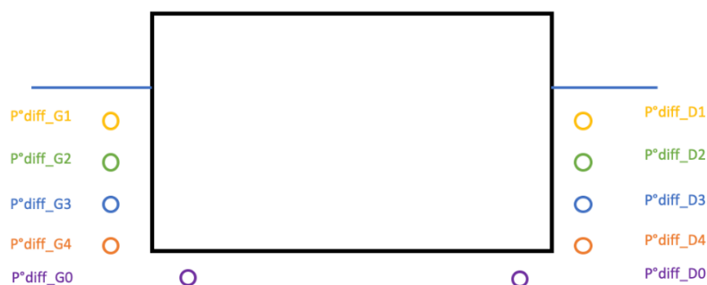
Figure 5-55 : Coupe Maillage illustrée - Prises de pression avec bateau - Cas Carène-Référence
