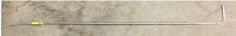
Figure 4-36 : Tube coudé à ouverture sur les cotés
