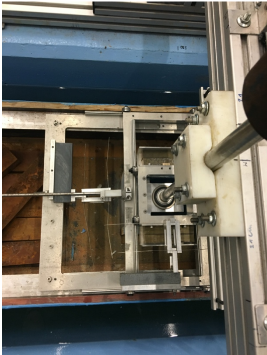
Figure 4-16 : Système d'amarrage amont – Vue du haut
