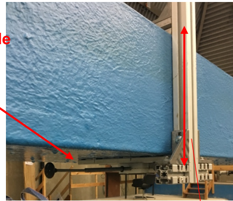
Figure 4-53 : Sonde de vitesse sur bateau - Mesure en-dessous
