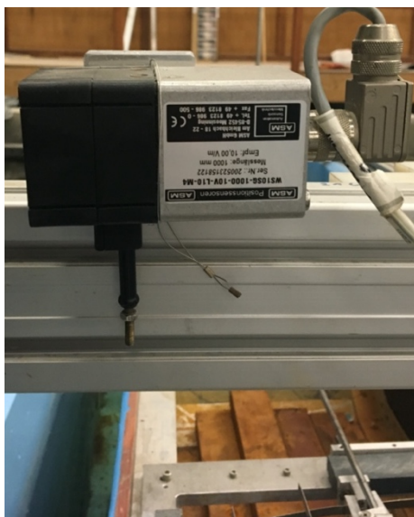
Figure 4-38 : Capteur de position à corde ASM WS10SG
