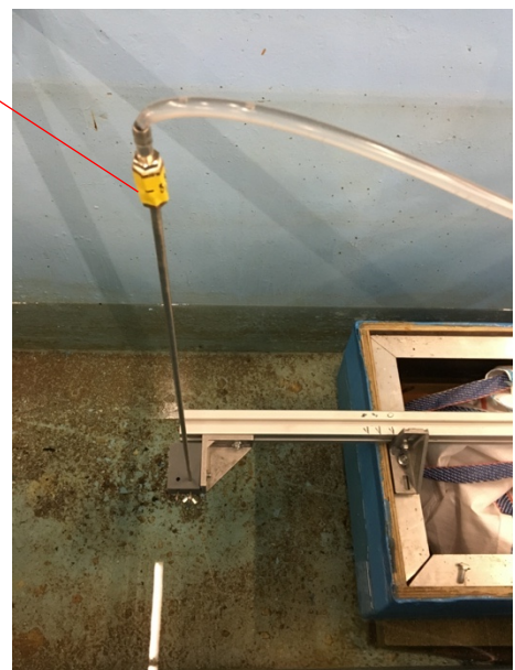
Figure 4-62 : Image modèle réduit - Prises de pression à la position de référence - Cas Carène-Référence ( P_{diff-3} )
