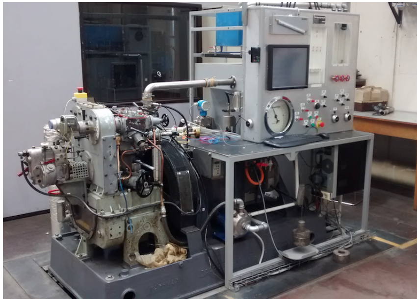
FIGURE 1.1 – Banc d'essais du moteur Varimax
