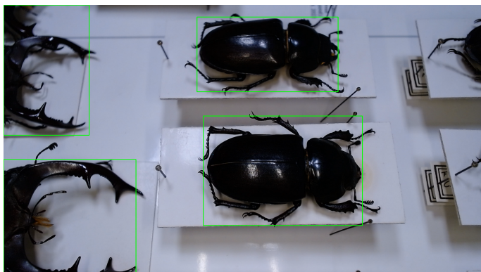
FIGURE 2.5 – Encadrement des contours avec une aire minimale de 1840 pixels carrés et une aire maximale de 2000000 pixels carrés
