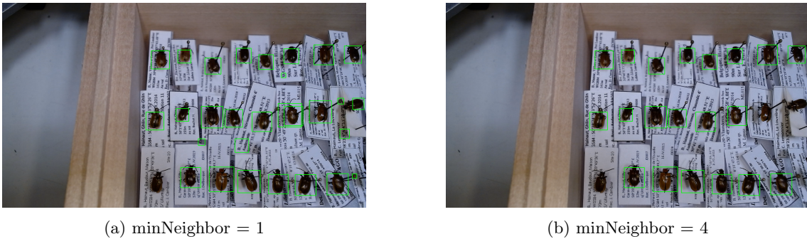
FIGURE 2.10 – Détection de Chrysomelidae avec un classificateur en cascade entraîné sur cette famille pour différents nombres minimum de voisins (scaleFactor constant = 3)
