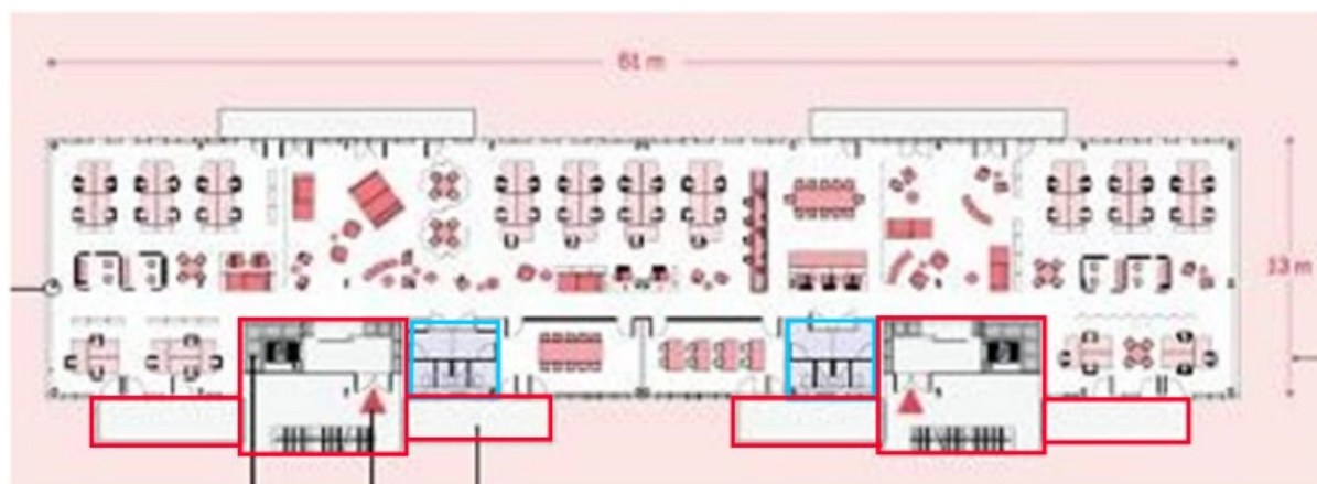
Fig. 26 : Adaptabilité bureaux (en rouge : circulation, en bleu : pièces d'eau) Source : CANAL Architecture, 2015. Document retravaillé par l'auteur.
