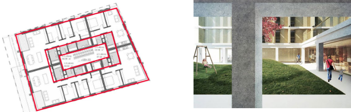
Fig. 42 : Système à 3 noyaux concentriques (à gauche) ; Ambiance extérieure (à droite) Source : KADERSTUDIO. Document retravaillé par l'auteure
