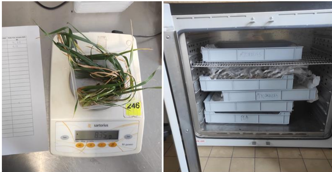
Figure 30. Pesée des parties racinaires pour déterminer le poids frais (A) et séchage des parties aériennes et racinaires dans une étuve à 70°C pendant 5 jours (B).
