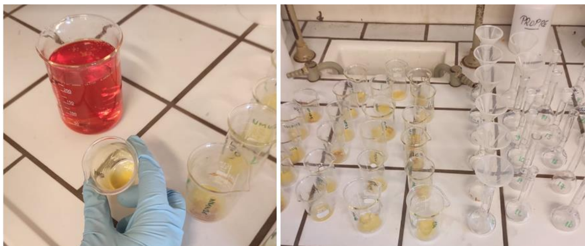
Figure 35. Les résidus ont été dissous avec 4 ml d'eau « régale » (3ml HCL 38% pour 1ml \text{HNO}_3 65%).
