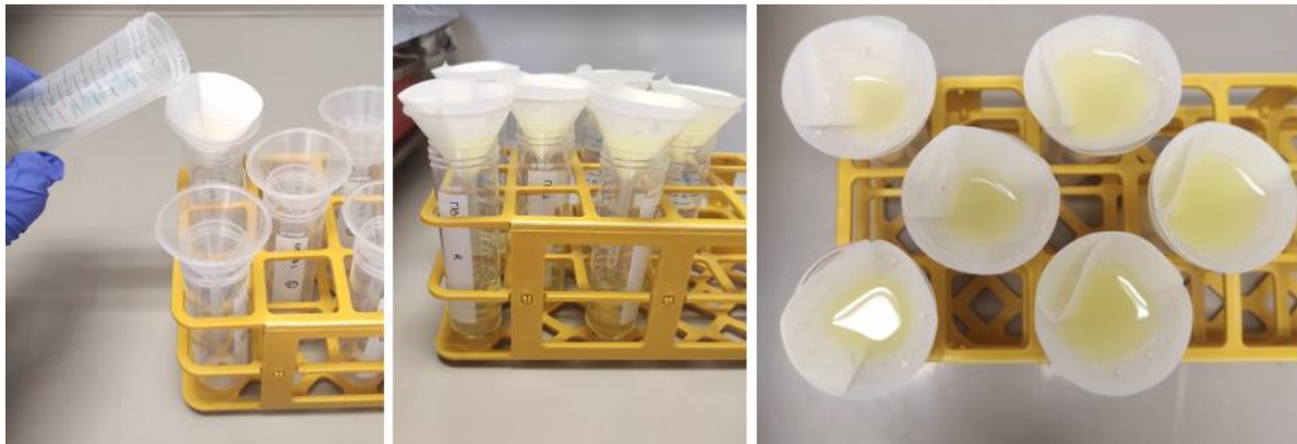
Figure 36. Les solutions ont été filtrées à l'aide de papier filtre Whatman (grade 41) de porosité de 20 micromètres.
