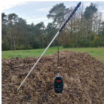
Figure 21 : Thermomètre numérique et sonde de 2m
