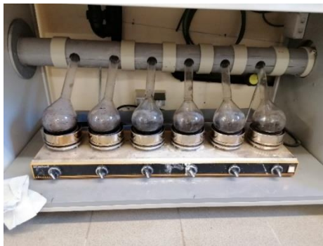
Figure 8 : Méthode Kjeldahl : Digestion de l'échantillon dans l'acide sulfurique
