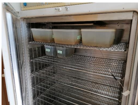
Figure 6 : Étuve pour le séchage des échantillons à 60°C
