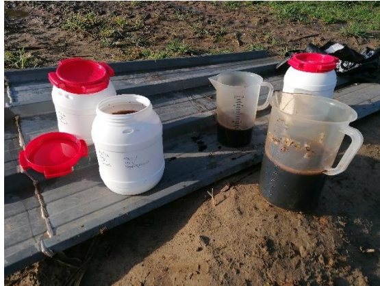
Figure 20 : Photo illustrant l'échantillonnage des jus de lessivage et de ruissellement
