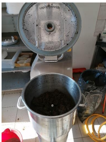
Figure 7 : Broyeur à couteau à volume conséquent
