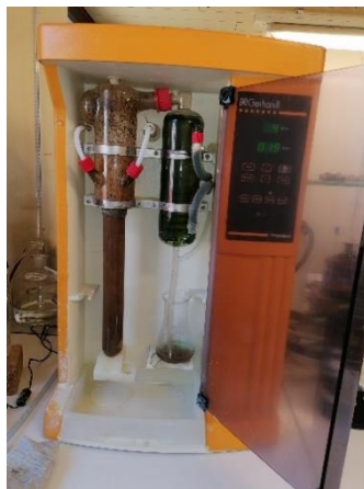
Figure 9 : Méthode Kjeldahl : distillation avec l'appareil de distillation Büchi K-355
