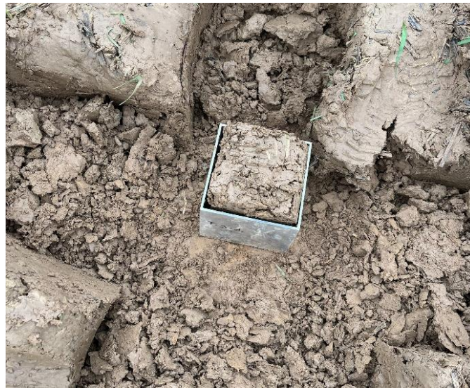
Figure 7 - Photo de l'échantillonnage d'une Vergière avant de mettre la paraffine chaude. Photo personnelle.
