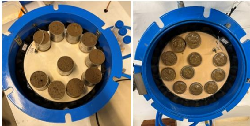
Figure 13 – À gauche : échantillons sur la plaque poreuse, dans la casserole à basse pression. À droite : échantillons sous forme de boue sur la plaque poreuse, dans la casserole à haute pression. Photos personnelles.
