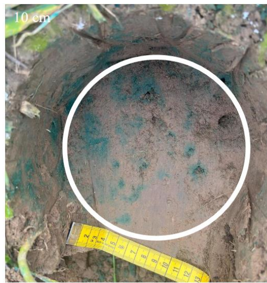
Figure 15 - Exemple d'une coupe dans le sol après infiltration d'une solution de colorant Brilliant Blue. La surface analysée est délimitée par le cercle blanc. Photo référencée modalité ABC, zone d'échantillonnage 1, profondeur de 10 cm. Photo personnelle.
