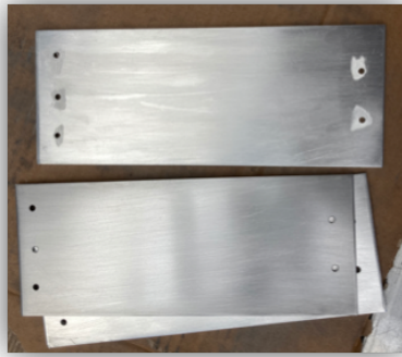
(a) Surfaces de contact polies et nettoyées à l'éthanol
