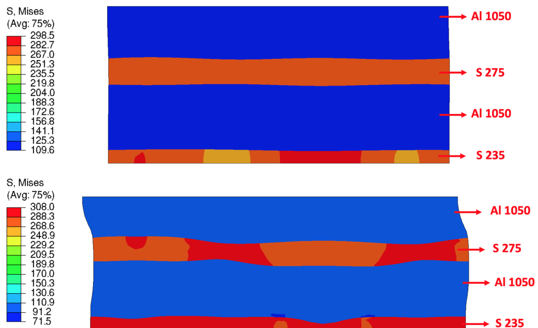
FIGURE 5.6 – (1) Résultat de la simulation ABAQUS montrant les champs de contraintes de Mises selon le paramétrage initial. Les deux images ont été enregistrées à des moments consécutifs t_1 et t_2 de la déformation.
