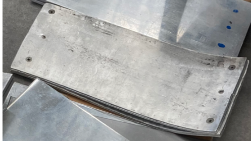
FIGURE 3.11 – Structure comportant deux structures à 3 couches laminées et séparées par une couche d'acier de base. Avant le second laminage.
