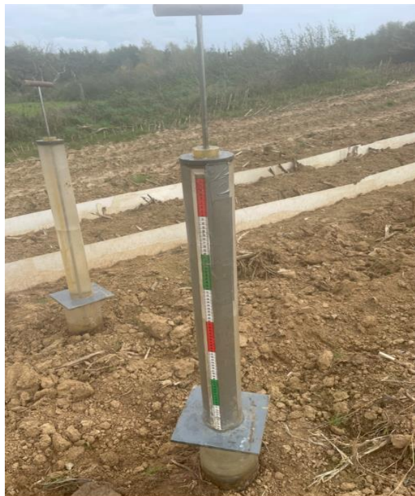
Figure 7: Infiltromètre simple anneau
