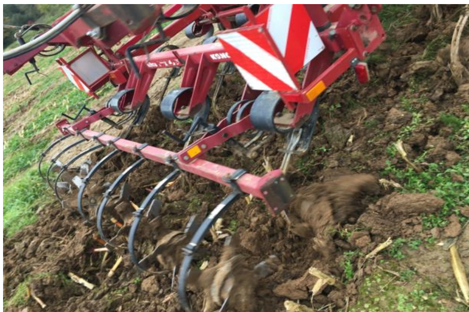
Figure 20: Travail du sol à l'aide du vibroculteur (déchaumage).
