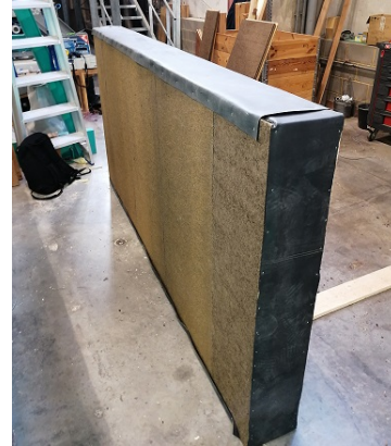
FIGURE 7.1 – Exemple de paroi pleine avec sa membrane en caoutchouc.
