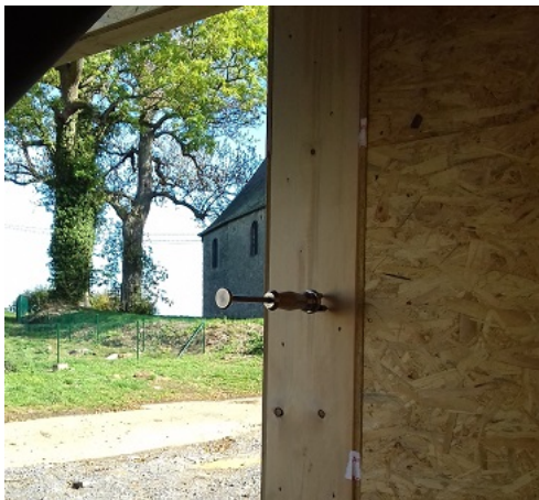
FIGURE 5.3 – Électrode à marteau lors de la prise de mesure d'humidité d'un montant vertical d'un mur extérieur.
