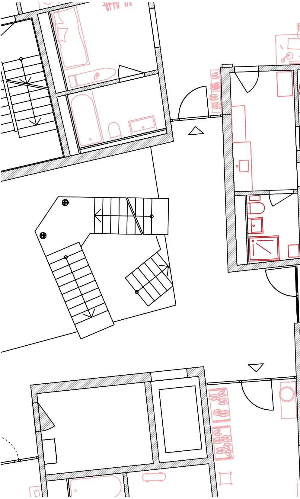
La cage d'escalier tournante de la Haus A de Mehr Als Wohnen
