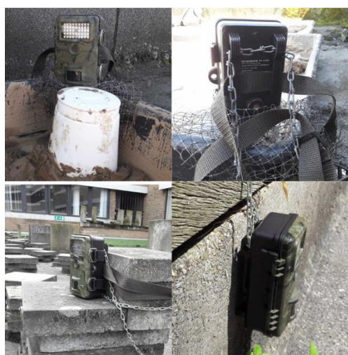
Figure 17 : Installation des caméras trap.
