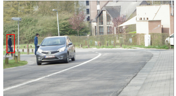
FIGURE 5.3 – Détections de piétons obtenues par la caméra pour un taux de certitude de 50% (le cadre rouge apparaît dès que la caméra détecte un piéton à cet endroit)
