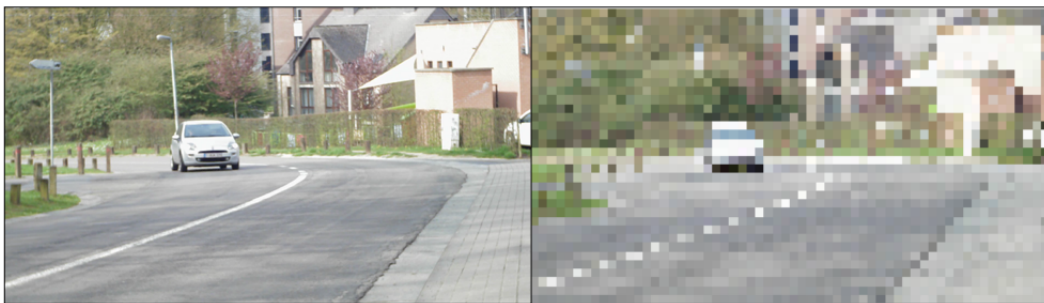
FIGURE 7.3 – Exemple de décimation d'une image de résolution 1920x1080 (image de gauche) par 32 (image de droite)
