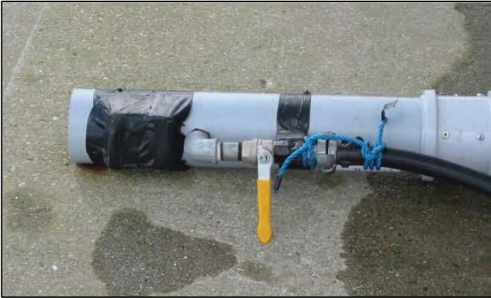
Figure 32. Exemple d'un système de pompe à air à usage archéologique sous-marin, nommé airlift dans VIDUKA A. J., 2012, p. 19.
