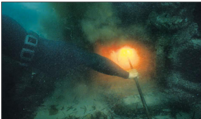
Figure 36. Utilisation d'une lance thermique sur un site archéologique sous-marin, dans VIDUKA A. J., 2012, p. 18.
