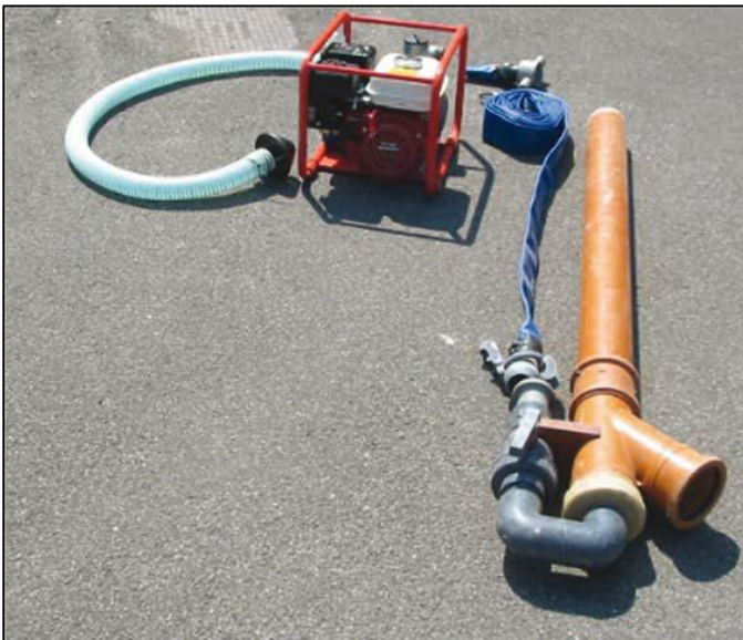
Figure 34. Dispositif de pompe de dragage à eau, ou water dredge ainsi que générateur, dans VIDUKA A. J., 2012, p. 21.
