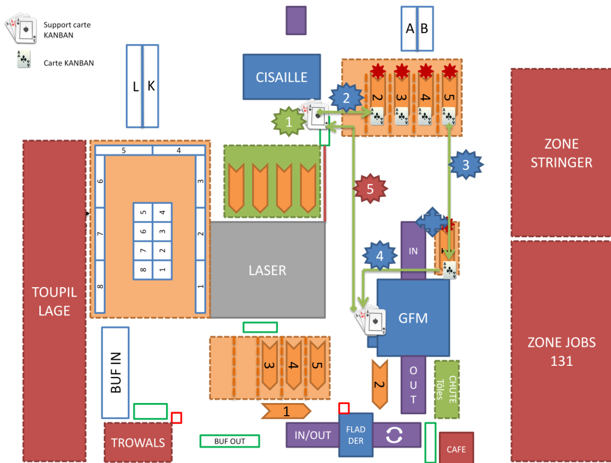
Figure 97: flux des cartes KANBAN dans l'atelier
