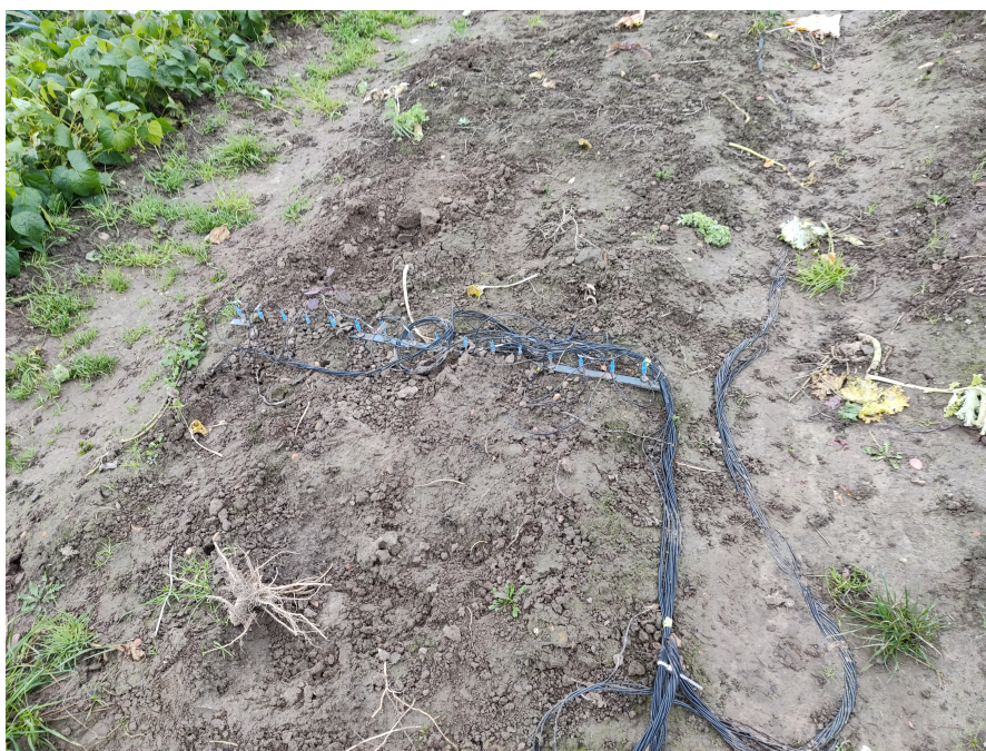
FIGURE E.3 – Dispositif ERT installé après avoir récolté les plantes
