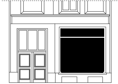
1880 Une double porte qui couvre la moitié de la largeur de la façade Accès commun au commerce et aux étages
