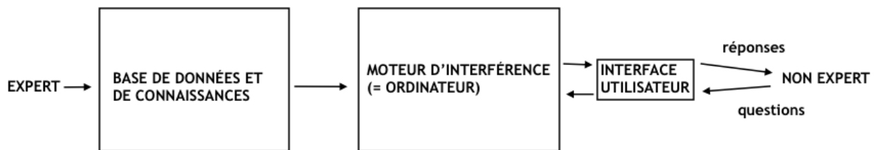
Schéma 1. Illustration d’un système expert. Pour mieux comprendre, le moteur de recherche Google est un excellent exemple de système expert.
