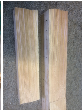
FIGURE 10.5 – Rupture par détachement du talon
