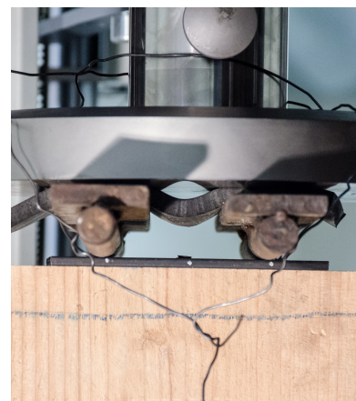
FIGURE 10.9 – Appuis à rouleau inférieur (sous l'entrait) et supérieur (sur l'arbalétrier)
