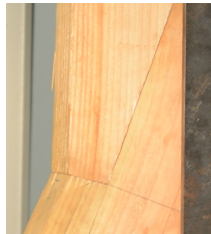
FIGURE 12.3 – Photo prise juste avant la rupture par détachement du talon
